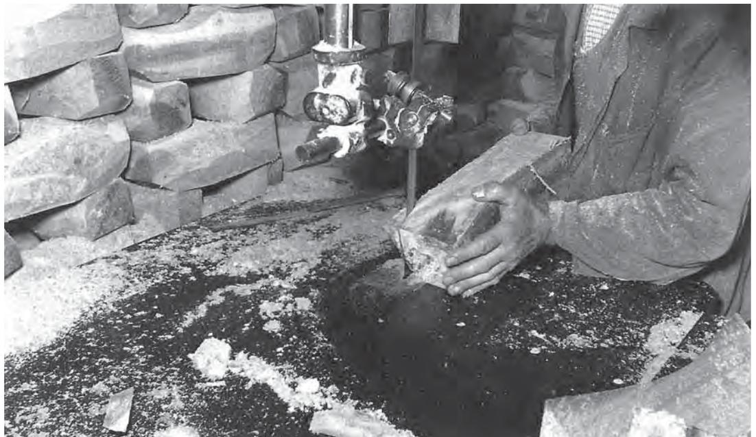
*Aus dem Klotz wird auf der Bandsäge ganz grob die Form des Holzschuhes zugeschnitten.*
