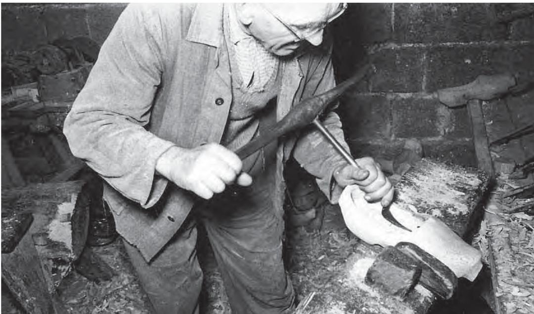
Das Innere des Holzschuhes wird ausgebohrt
